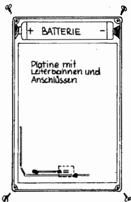
Rückseite des Rechners (aufgeschraubt und Rückplatte entfernt) Die Lötstellen für das Gleichheitszeichen sichtbar!
