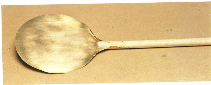
Abb. 24: Ein sehr schön aussehender Schieber (für Pizza) aus Messingblech und einem Besenstiel.
