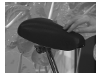
Konventioneller Fahrradsattel. Leicht nach vorne gekippt wird die Sitzfläche auf den unempfindlicheren Steißbeinbereich verlagert.
