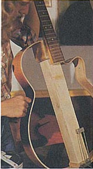
Abb. 3: Die eingebaute Holzverstärkung
