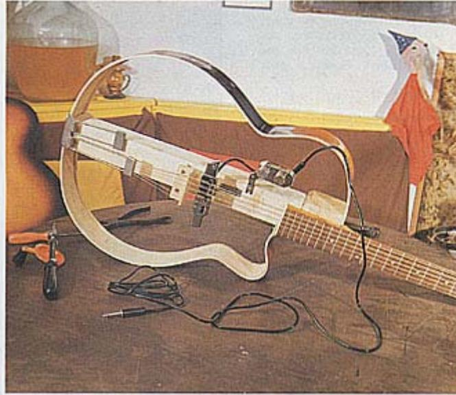
Abb. 4: Ein magnetischer Tonabnehmer und ein Potentiometer sind montiert
