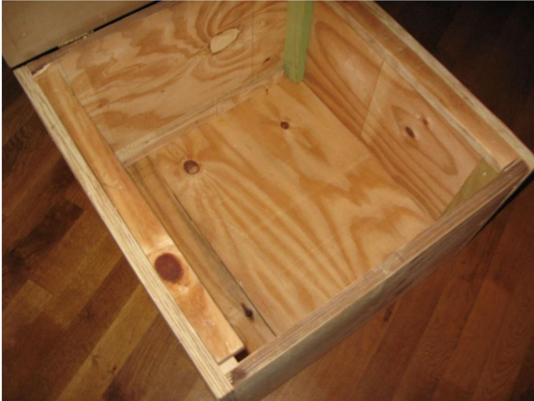
Beim Zusammenschrauben zunächst auf den Boden rundum Latten Schrauben (um die Stärke der Bretter nach innen versetzt). Dann die Seitenteile anschrauben; auch hier in den Ecken Latten anschrauben und die Seitenteil über die Latten verbinden. Dann die Küchenplatte mittels der Scharniere am hinteren Rand mit Schrauben befestigen, rundum liegt so die Küchenplatte auf.
