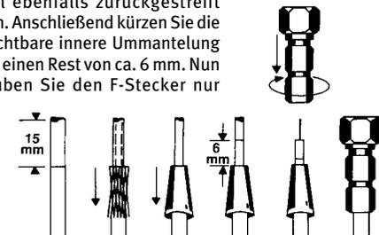
noch mit dem wesentlich längeren Gewinde über die Ummantelung des Antennenkabels fest. Am Ende schneiden Sie den inneren Draht so ab, dass er nur noch etwa 2mm über den Stecker hinausragt. Was sich
