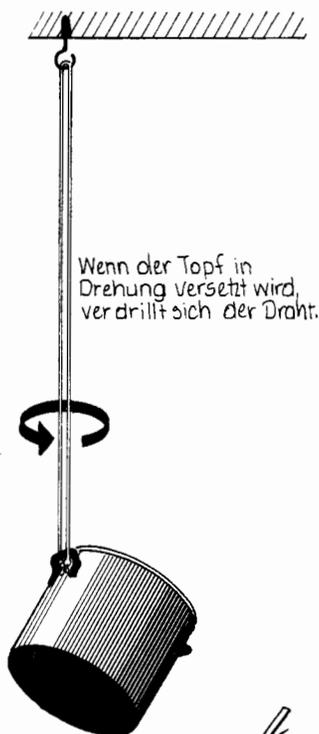
Wenn der Topf in Drehung versetzt wird, verdreht sich der Draht.
