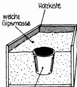
Trinkbecher mit Wasser gefüllt - und die Auftriebskräfte sind überlistet.
