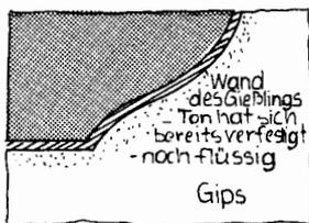
weiter Wasser aus dem Gießling, läßt ihn antrocknen und - durch den Flüssigkeitsverlust - ein wenig schrumpfen. Nach einer Weile können wir den nun lederartig trockenen Gießling aus der Gipsform nehmen - und erneut Gießton einfüllen. Der Gips der
