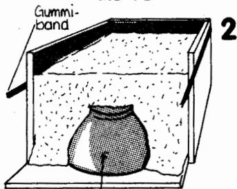
Zum beschweren mit Ton gefüllt - verhindert Auftrieb.
